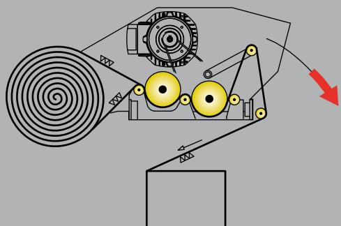
● Sistema di prestiro motorizzato comandato elettronicamente con rapporti intercambiabili: 150 - 200 - 250%.
