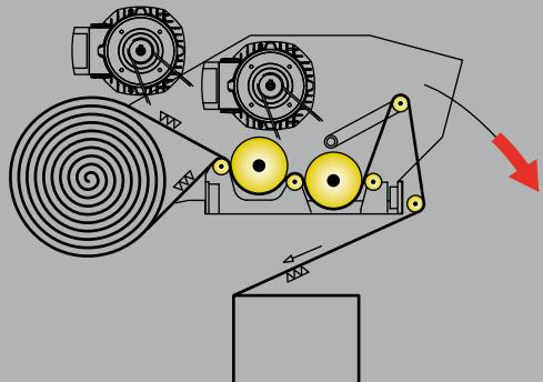
● Sistema di prestiro motorizzato a 3 rulli con 2 motori e variazione continua da 120 a 350% regolabile da quadro comandi.
